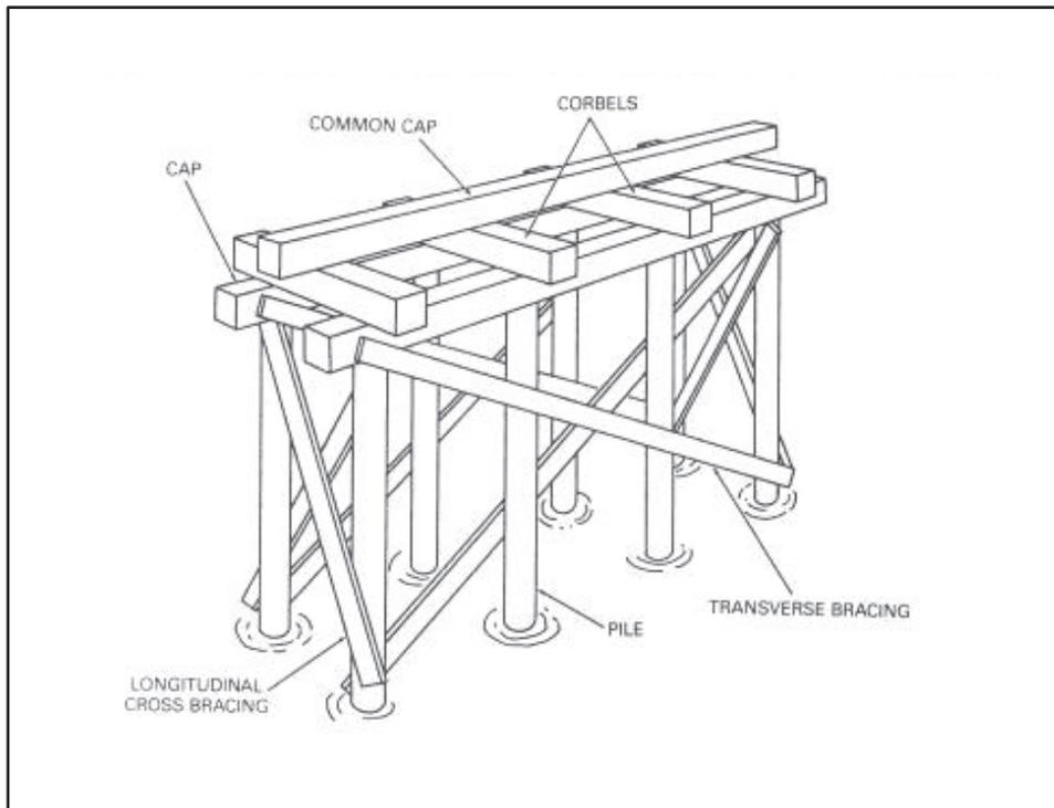
Figure 10-5. Pile-bent pier
